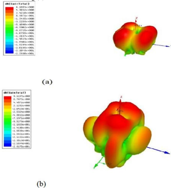
Figure (4): Total antenna numerical Gain at 9and 11 GHZ.
