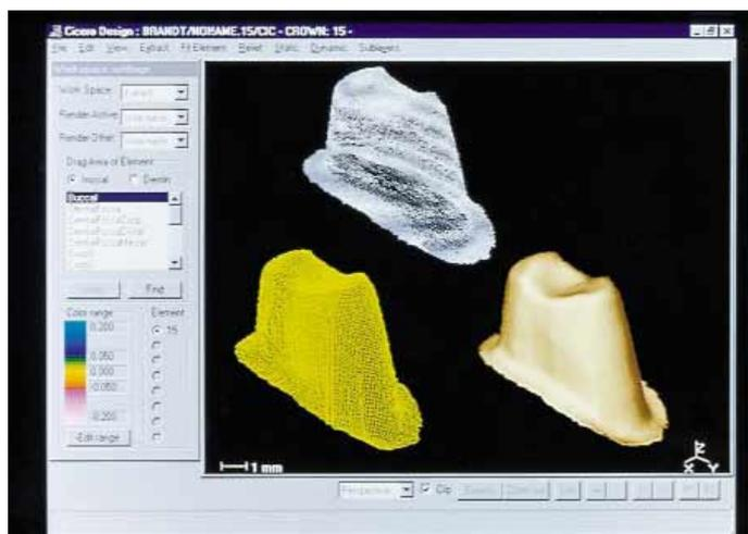
**FIG. 4 COMPUTER GRAPHIC PRESENTATION OF SCANNED DIE**
