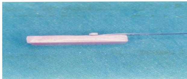
**WIRE LOOP CONTOURED AROUND BASE OF CYLINDER**
