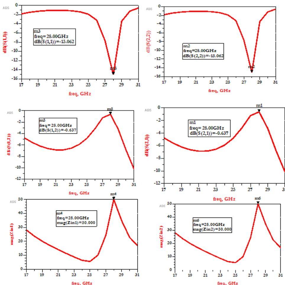
Figure 7: Stub S parameters
