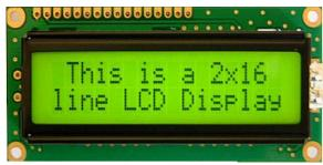
Fig. 5. LCD Display
