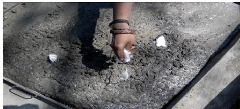
FIG.3.9. SCC MIX WITH HYBRID FIBERS STEEL
