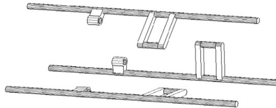
Fig. 8-Short Rocker-Arm, Rocker-Shaft and Long Rocker-Arm
