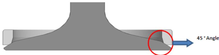
Fig. 2.4.1 Valve & Valve Seat Angle (45°)
