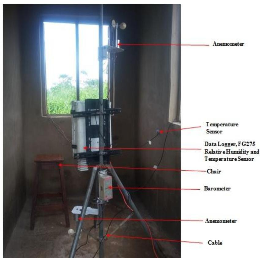
**Plate 4:** Experimental Set Up
