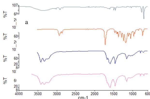
**Fig. 8. FTIR Spectra of PS - PCL blend (d)<sup>28</sup>**
