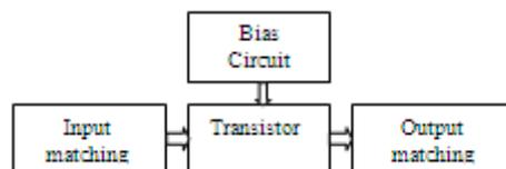
Figure 1 Simple Block Diagram For LNA
