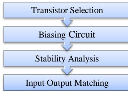
**Figure 2:** Design steps for LNA
